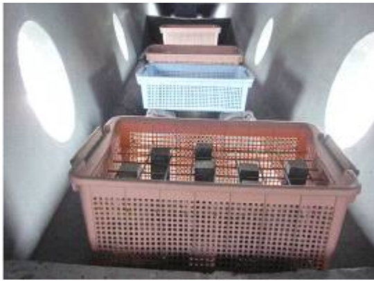
写真2 箱桁内における供試体の暴露状況
