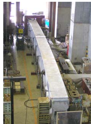
曲線軌道桁載荷実験
